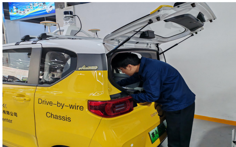
图 5 校企共研汽车智能无人驾驶改装
