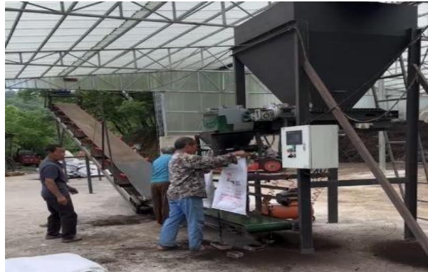
图 3-19 专家团设计的称重打包流水线
